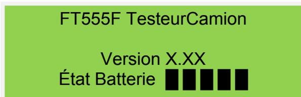
L’écran ci-dessus sera l’écran d’affichage initial chaque fois que le testeur automatique de camion FT555PA/PW est allumé. Cet écran affiche la version du micrologiciel (firmware) du FT555PA/PW et l’état de santé de la batterie sous forme de barres. 5 barres représentent la pleine capacité de la batterie.
